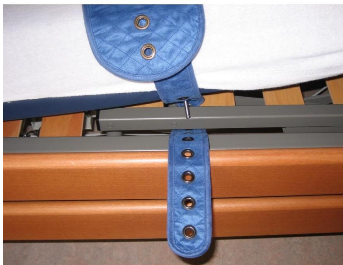
Vastmaken van de Roll Belt aan het beweeglijk deel van het hoofdeinde van het bed.
